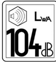
**Figure 99: Pictogramme marquage CE, conforme aux directives européennes 2005/88/CE et 2006/42/CE**
