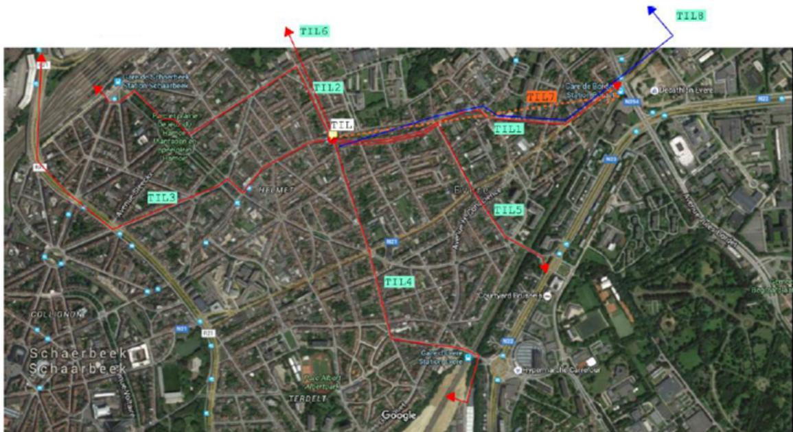
**Figure 13 : Scénarios de préacheminement des déblais de la station Tilleul (BMN, 2016)**
