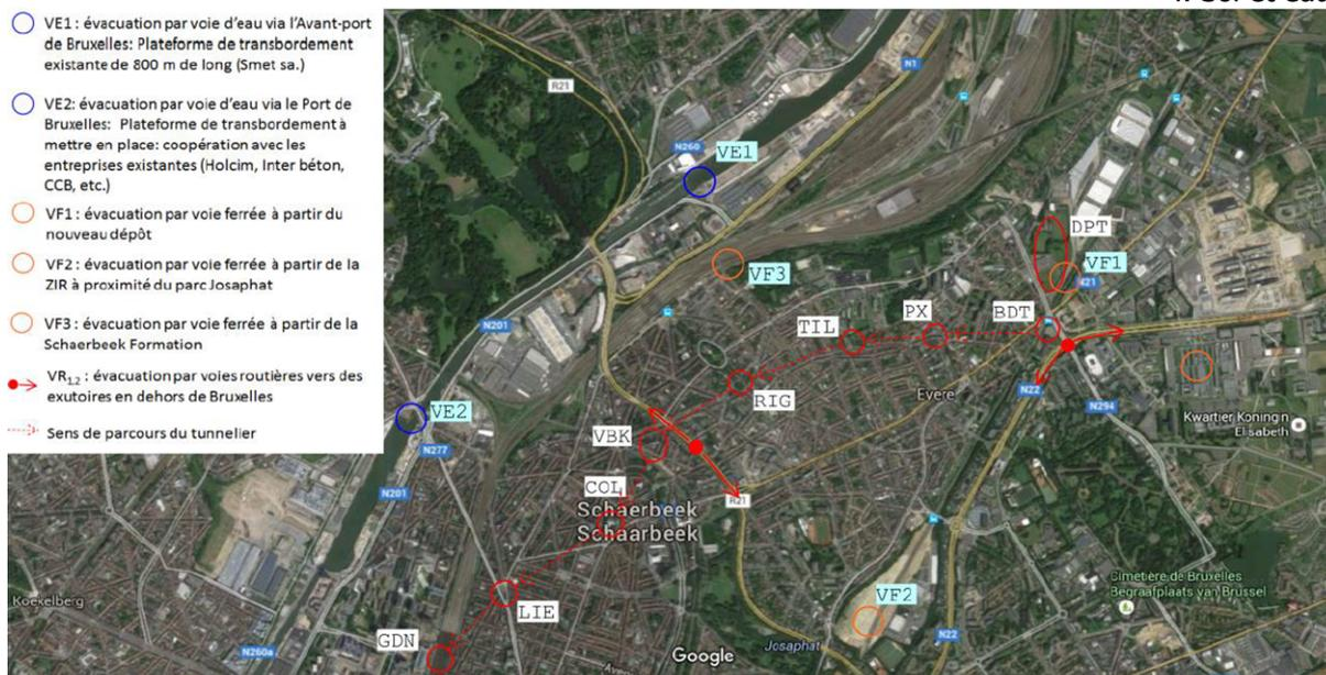
**Figure 11 : Localisation des zones potentielles de stockage des déblais des stations (BMN, 2016)**
