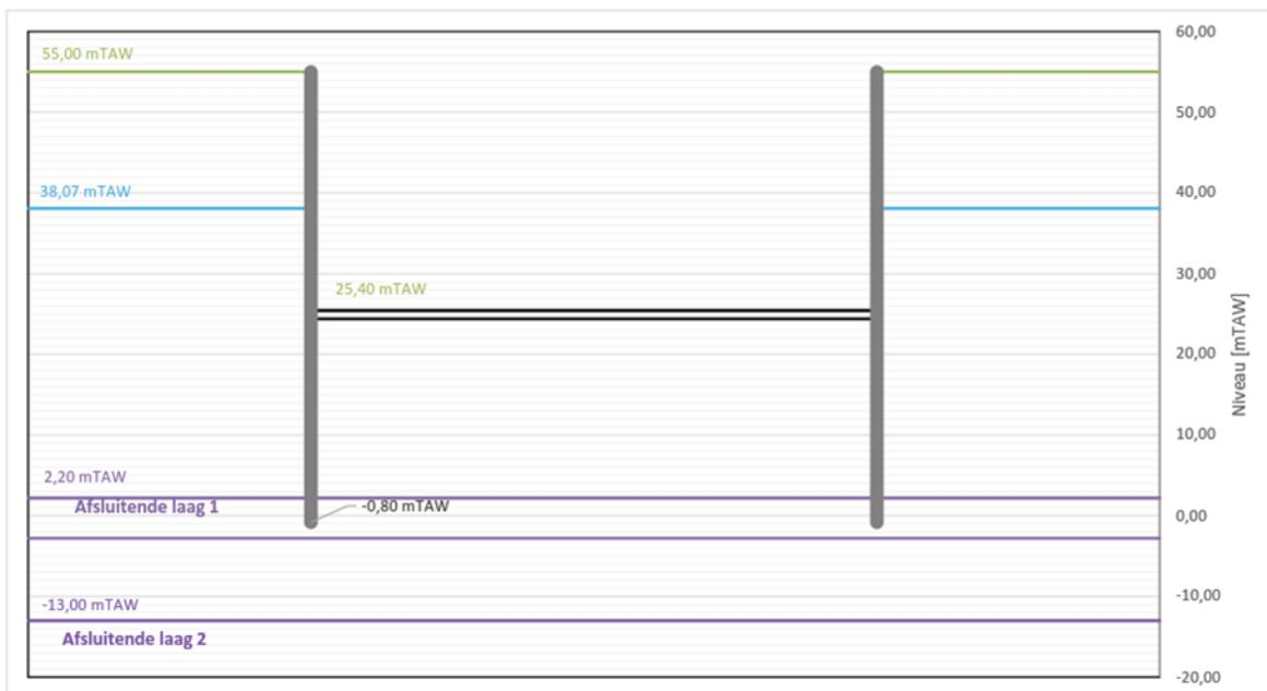
**Figure 6 : Illustration schématique de la coupe du modèle Plaxis 2D (BMN, 2020)**
