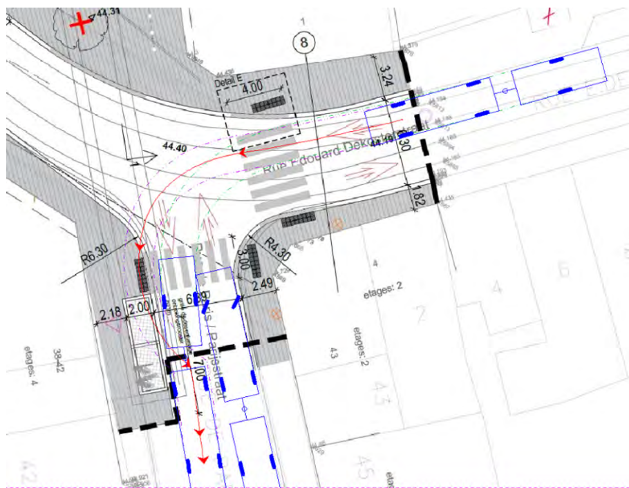
Figure 54 : Giration des bus articulés (18,75m) en entrée/sortie de la rue de Paris (ARIES, 2020)
