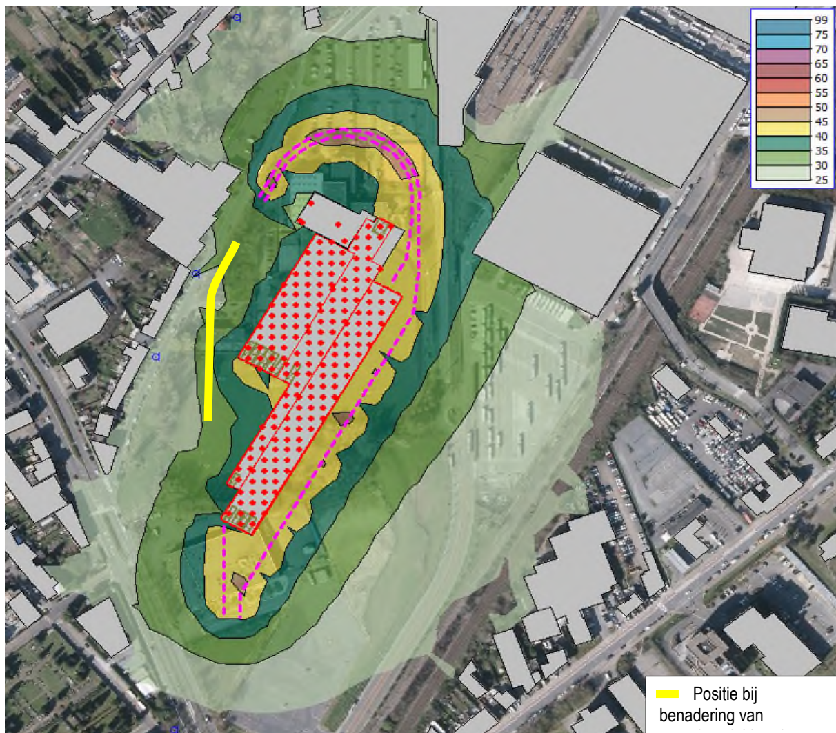
Figuur 206: Geluidskartaal (L Aeq,1h ) als resultaat van de modellering van het lawaai afkomstig van het project met de inverkeerstelling van 6 metro's (Tractebel, 2020)
