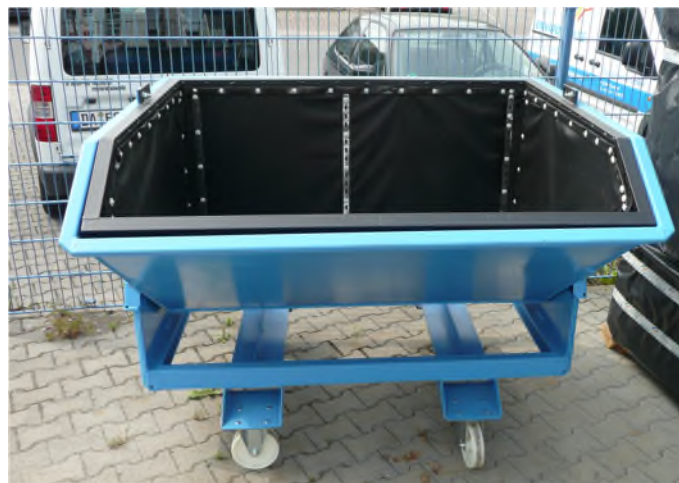
Figuur 347: Voorbeeld van de container waarin het drijfsel van de waterbehandeling van de werkplaats en het ontvettingsspoor worden opgeslagen (MIVB, 2020)
