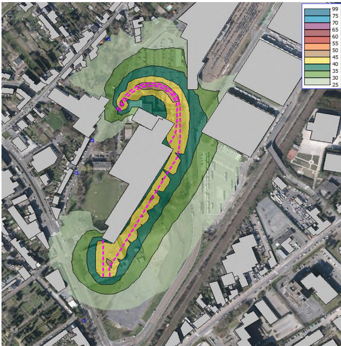
Figuur 202: Geluidskaart ( L_{Aeq,1h} ) resulterend uit de modellering voor het verkeer van 6 metro's (Tractebel, 2020)
