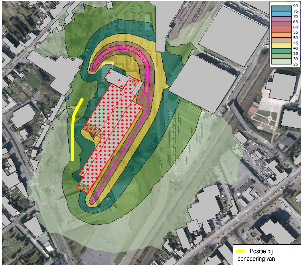
Figuur 205: Geluidskartaal (LAEq,1h) als resultaat van de modellering van het lawaai afkomstig van het project met de inverkeerstelling van 13 metro's (Tractebel, 2020)
