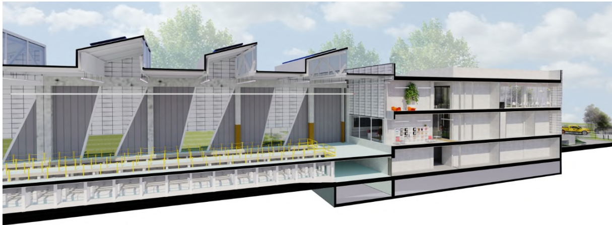
Figuur 83: Lengtedoorsnede van het project (BMN, 2017)
