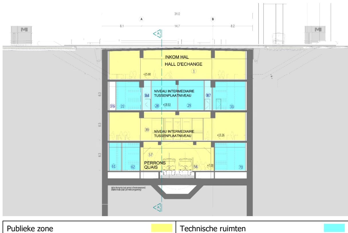
Figuur 52: Station Colignon, dwarsdoorsnede (BMN, 2018)
